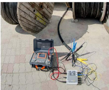
Mehrere Messungen durch einmaligen Anschluss
